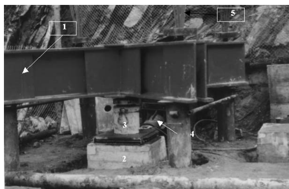
Figura 7. Echipamentul de efectuare a testelor de compresibilitate și forfecare: 1- grindă de contrapresiune; 2- blocul de beton; 3 - presă hidrolică de 3000 kN pentru efort vertical; 4- presă hidrolică pentru efort orizontal; 5 - ancore
