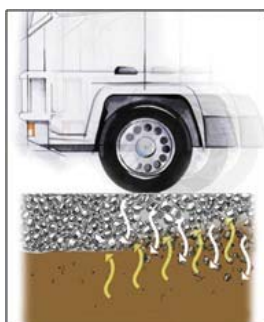
Figura 1. Fundație fără geotextil
