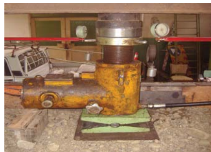
Figura 6 Detaliu sistem de încărcare: plăcuțe – cric – comparatoare și senzor de presiune
