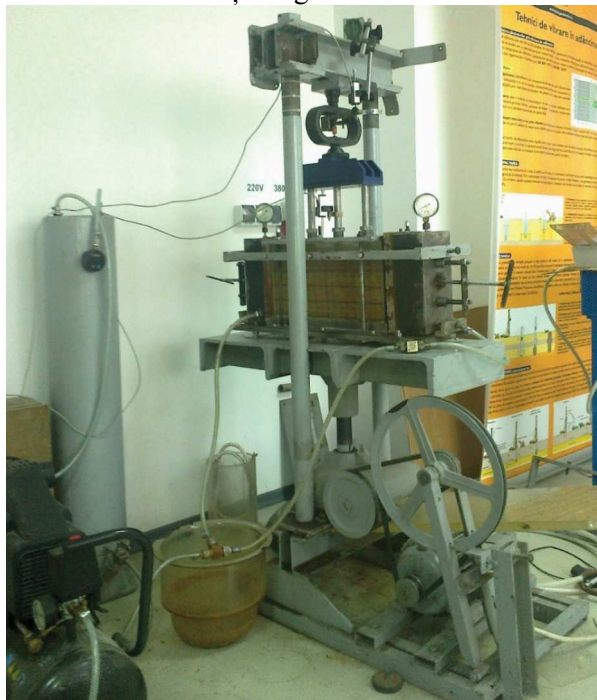
Figura 1 – Aparat de compresiune în stare plană de deformații-Facultatea de Construcții și Instalații din Iași
