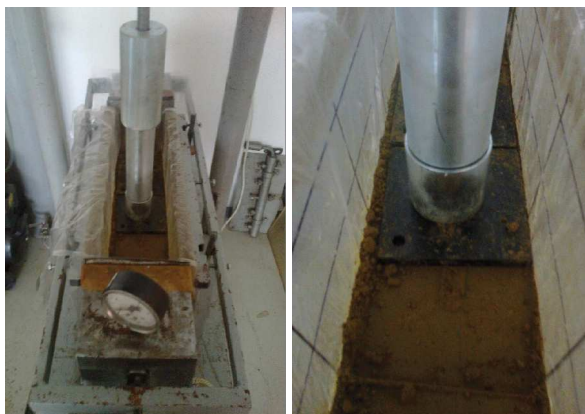
Figura 6 – Compactare pământului coeziv în interiorul celulei biaxiale
