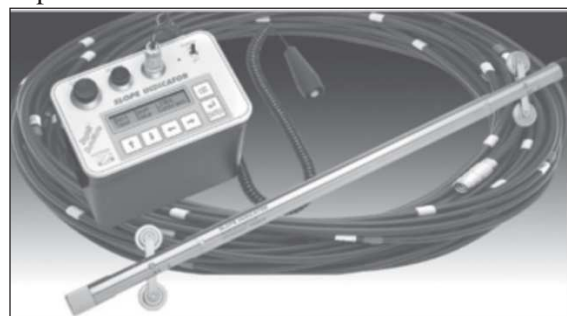
Figura 5. Sistem inclinometric [Dunnicliff]
