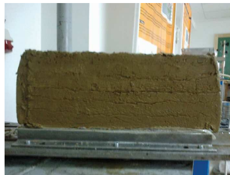
Figura 7 – Proba de pământ coeziv, după efectuarea încercării biaxiale
