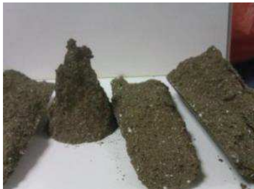
Figura 10 – Probă de argilă stabilizată după încercarea la compresiune monoaxială
