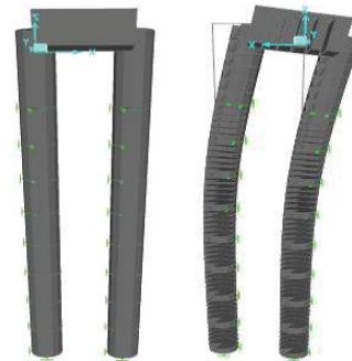
Figura 9. Modelarea sistemului de consolidare Varianta 3 (2D) formă nedeformată/deformată
