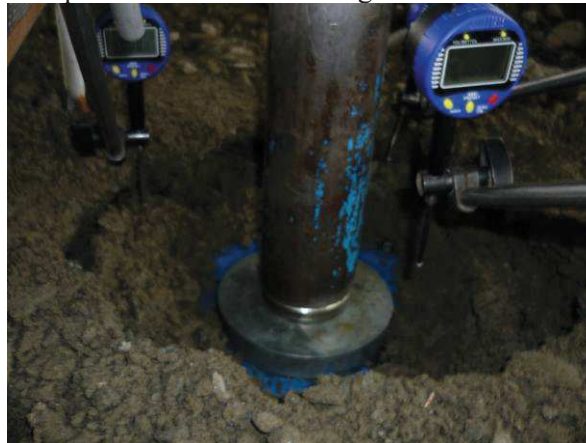
Figura 4. Treapta de încărcare de 350 kPa determină prăbușirea stratului de pământ
