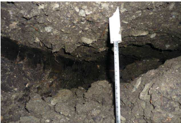
Figura 2. Prăbușirea progresivă a golului sub încărcări statice
