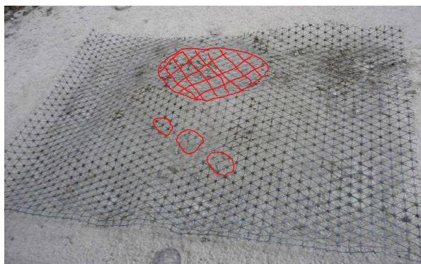
Figura 7. Conul de presiune și cele trei puncte de cedare orientate după o diagonală
