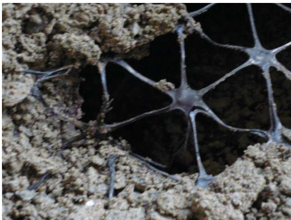
Figura 6. Cedare în lungul fibrei a geogrelei triaxiale
