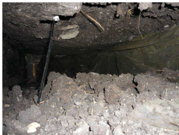
Figura 8. Bucăți mari din tavanul golului se prăbușesc sub treapta de încărcare de 350 kPa
