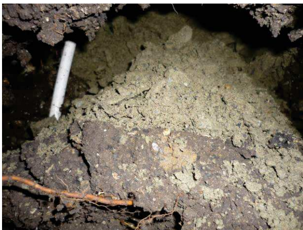
Figura 9. Golul este prăbușit sub treapta de încărcare de 550 kPa
